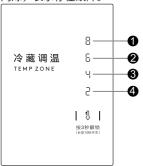
● 闪烁:冷藏室温度传感器故障 ⑤ 闪烁:冷冻室除霜传感器故障 ④ 闪烁:环境温度传感器故障
