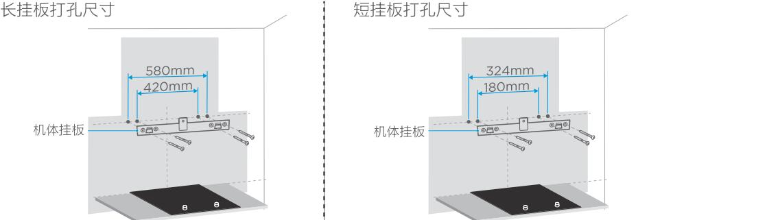
按照图示在墙壁相应位置钻出直径为8mm、深度为50~60mm的孔，将塑料膨胀管压入孔内，再用随机配备的M5×50沉头螺钉将机体挂板可靠固定。
