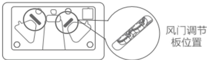
风门调节板位于灶具的底部，对火焰燃烧状况起调节作用。正常情况下，灶具的风门已经调节好，无需调节，燃烧时火焰呈蓝色，清晰稳定。
