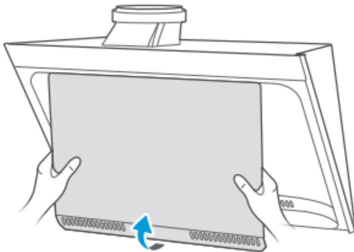
取出油杯，双手向外用力，打开冷凝板下端。
