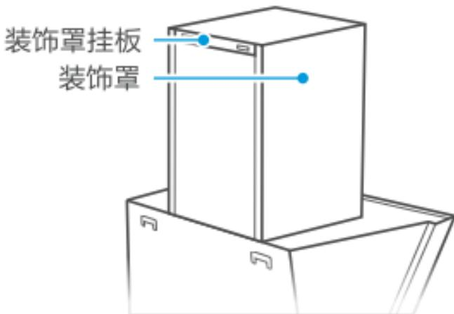
先用十字螺丝刀将3颗ST4.2×16十字槽大扁头自攻螺钉固定到箱体顶板上对应的3个螺钉孔内，然后将装饰罩底部折边上的卡扣孔套进对应的3颗ST4.2×16十字槽大扁头自攻螺钉根部，并向机体后部推到位，最后把装饰罩挂板扣到装饰罩后侧上部的孔上即可。
