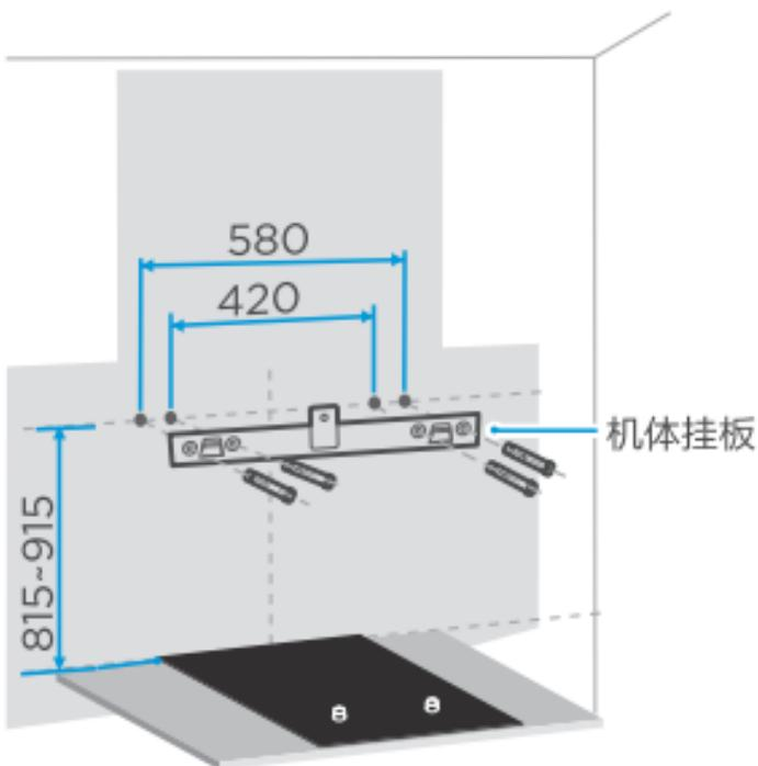
按图所示在墙壁相应位置钻出4个直径为8mm、深度为50–60mm的孔，将塑料膨胀管压入孔内，再用随机配备的M5×50沉头螺钉将机体挂板可靠固定。
