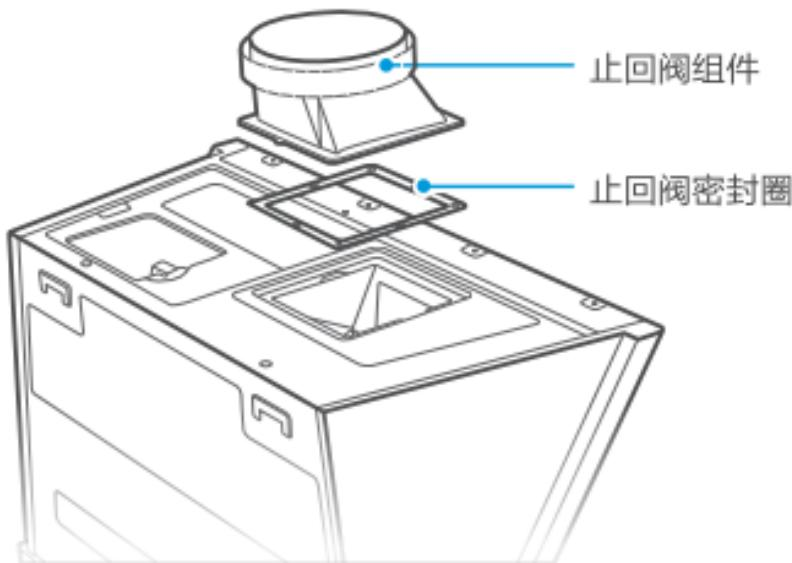
将止回阀组件连同止回阀密封圈安装在机架出风口位置，用随机配备的 ST4.2×16 的螺钉紧固，检查并确保阀片转动灵活。
