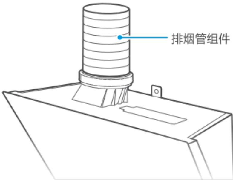
将排烟管一端插入止回阀凹槽内，用随机配送的ST2.9×9.5自攻螺钉将排烟管固定在止回阀中，再用排烟管上的铝箔胶带缠绕在止回阀与排烟管
