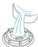
5 添加盐过程中，若有盐洒在内胆，必须运行程序冲洗一次。否则可能腐蚀内胆、过滤网、电机等，造成洗碗机损坏。
