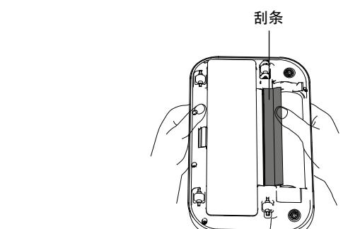
5.刮条拆装：机身底部朝上，用大拇指往下用力按压刮条直至拆下。
