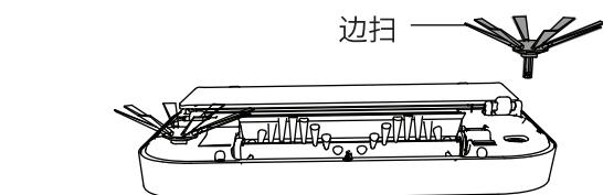
1.使用一段时间后，边扫可能缠绕毛发，可将边扫拔下清理。
